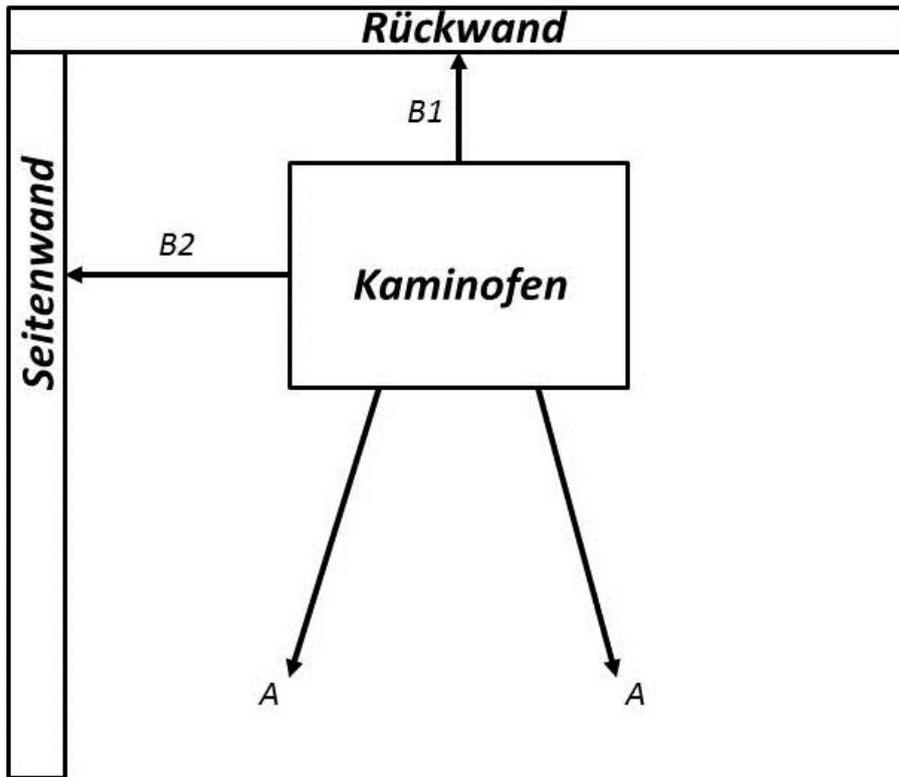
**ACHTUNG: der Abstand zu brennbaren Baustoffen im Strahlungsbereich (A) muss auch dann eingehalten werden, wenn der Ofen um 80° (40° in jede Richtung) gedreht wird.**
