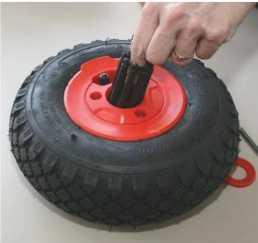
Mit einem Schraubendreher den kleinen Deckel heraus lösen, danach das Rollenlager entnehmen und mit Wasser reinigen.
