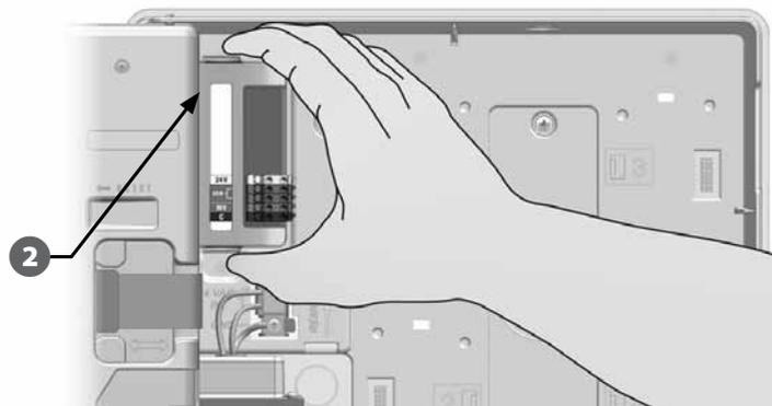
**!** **HINWEIS:** Um das Modul zu entfernen, drücken Sie die (beiden) Freigabetasten an den Modulseiten.
