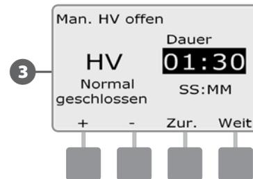
**!** **HINWEIS:** Die Funktion „Man. HV öffnen“ kann auch mit normal offenen Hauptventilen verwendet werden (NOHV). Ist Durchflusserfassung installiert, wird das Steuergerät mit dieser Funktion darüber informiert, dass eine manuelle Durchflussrate zu erwarten ist, wodurch ein Abschalten bei hohem Durchfluss (SEEF) verhindert wird.
