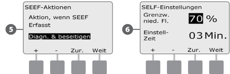
**7** „Einstellzeit“ ist ausgewählt. Damit können Sie einstellen, wie lange eine Stationsdurchflussrate auf der Höhe des Grenzwerts oder darunter liegen muss (3 bis 10 Minuten), bevor das Steuergerät einen Alarm auslöst oder eine Maßnahme ergreift. Drücken Sie die Tasten „+“ und „-“, um die Einstellzeit einzustellen. Drücken Sie dann „Weit“ (Weiter).
