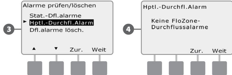
Notieren Sie jede Station mit einem Alarm und sehen Sie dann unter „Durchflussalarme löschen“ in diesem Abschnitt nach, wie Durchflussalarme gelöscht werden.
