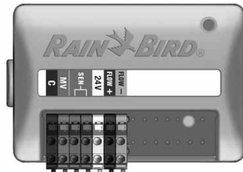
**! HINWEIS:** Das Basis- und Durchfluss-Smart-Modul beinhaltet einen Überbrückungsdraht zum Verbinden der Wettersensoranschlüsse (SEN). Entfernen Sie den Überbrückungsdraht nur, wenn Sie einen Wettersensor installieren. Weitere Informationen finden Sie in Abschnitt H unter „Installation“, „Lokalen Wettersensor anschließen“.
