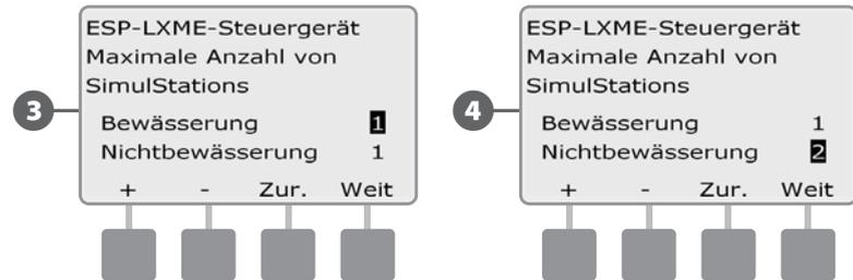
**HINWEIS:** Die Einstellung „Nichtbewässerungs-SimulStations“ dient zur Konfiguration der maximalen Anzahl von Nichtbewässerungsstationen, die gleichzeitig in Betrieb sein können. Damit können Sie die Anzahl der Bewässerungs- und Nichtbewässerungsstationen ausgleichen, die gleichzeitig in Betrieb sein können.
