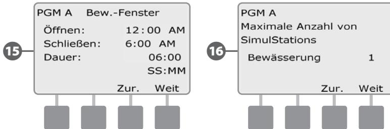
**17** Der Bildschirm „Maximale Anzahl von SimulStations“ für das Steuergerät wird angezeigt. Er gibt die maximale Anzahl der Stationen an, die gleichzeitig für dieses Steuergerät ausgeführt werden können. Drücken Sie „Weit“ (Weiter).
