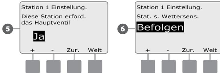
**!** **HINWEIS:** Der Wettersensor kann mithilfe des Wettersensor-Schalters an der Frontplatte des Steuergeräts eingeschaltet (Aktiv) oder ausgeschaltet (Umgangen) werden.
