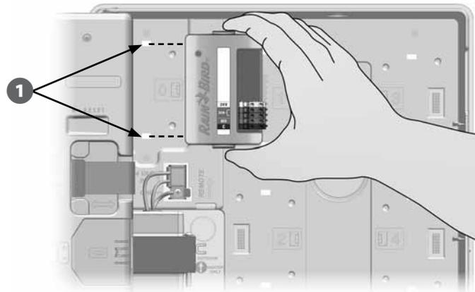
**2** Befestigen Sie das Modul vorsichtig an der Steuergeräterückseite. Drücken Sie dabei fest auf das Modul, bis es einrastet. Die rote Leuchte am Modul blinkt einmal auf, wenn das Modul korrekt installiert wurde. Blinkt die Leuchte nicht einmal auf, vergewissern Sie sich, dass das Modul korrekt eingesteckt ist.
