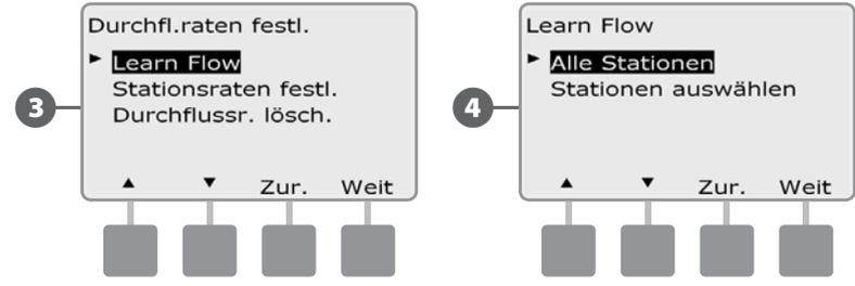
**!** **HINWEIS:** Sie müssen die Laufzeiten für alle in einer Learn Flow-Übung eingeschlossenen Stationen einrichten, bevor Sie einen Learn Flow-Vorgang einrichten. Nur Stationen mit Laufzeiten werden in den Learn Flow-Vorgang eingeschlossen.
