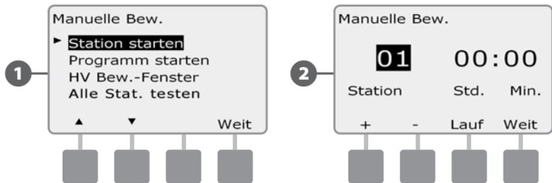
3 Die Stationslaufzeit wird standardmäßig auf die Programmlaufzeit eingestellt. Drücken Sie die Tasten „+“ und „-“, um die Stationslaufzeit anzupassen (von 0 Stunden, 1 Minute bis 12:00 Stunden). Drücken Sie „Lauf“, um die Bewässerung für diese Station zu starten.
