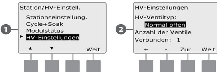
➌ Drücken Sie die Tasten „+“ und „-“, um die Anzahl der mit dem Hauptventilschaltkreis verbundenen Ventile einzugeben. Drücken Sie dann „Weit“ (Weiter).
