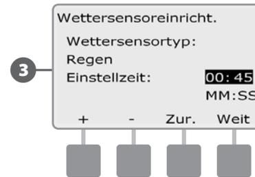
**! HINWEIS:** Der Wettersensor kann mithilfe des Wettersensor-Schalters an der Frontplatte des Steuergeräts eingeschaltet (Aktiv) oder ausgeschaltet (Umgangen) werden.
