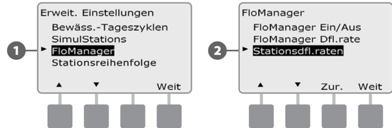
3 Der Bildschirm „Stationsdurchfl.raten“ wird angezeigt. Drücken Sie die Tasten „+“ und „-“ links, um die gewünschte Stationsnummer auszuwählen.
