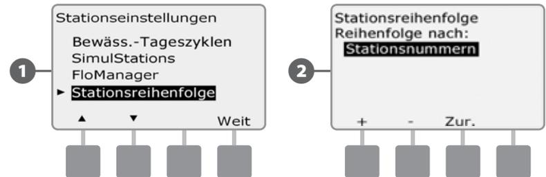
**!** **HINWEIS:** Ist die Stationsreihenfolge auf „Reihenfolge nach Stationsprioritäten“ eingestellt, können Sie weiterhin Stationen in der Reihenfolge der Stationsnummern manuell in Betrieb nehmen. Dazu verwenden Sie die Option „Alle Stationen testen“, wenn die Wählscheibe auf „Manuelle Bewässerung“ steht. Weitere Informationen finden Sie in Abschnitt G, „Zusätzliche Betriebsfunktionen“, „Manuelle Bewässerung“, „Alle Stationen testen“.
