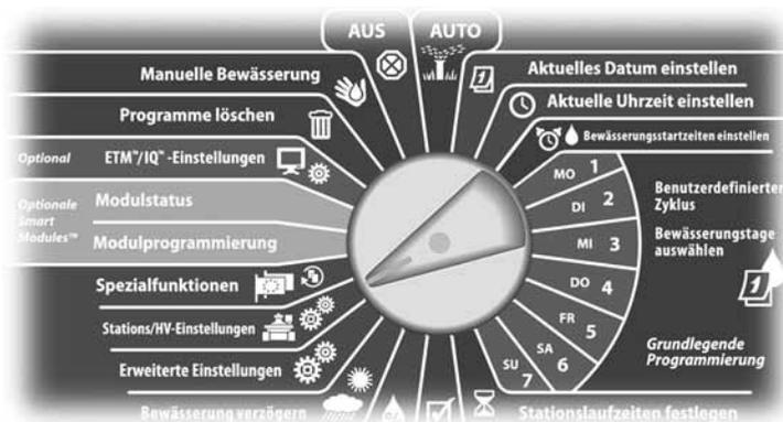
➊ Der Bildschirm „Station/HV-Einstellungen“ wird angezeigt. Drücken Sie die Taste mit dem Abwärtspfeil, um die Option für HV-Einstellungen auszuwählen. Drücken Sie dann „Weit“ (Weiter).
