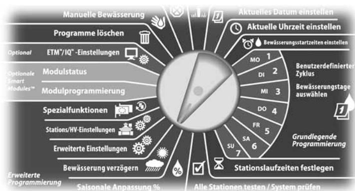
1 Der Bildschirm „Bewässerung verzögern“ wird angezeigt. Drücken Sie die Taste mit dem Abwärtspfeil, um „PGM Stationsverzögerung“ auszuwählen. Drücken Sie dann „Weit“ (Weiter).
