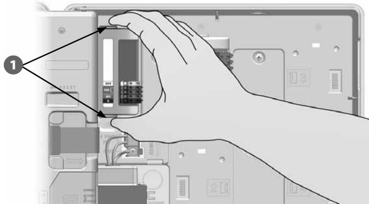
**⚠ ACHTUNG:** Achten Sie darauf, dass die Kontaktstifte in den Buchsen beim Anschließen des Moduls nicht verbogen werden.
