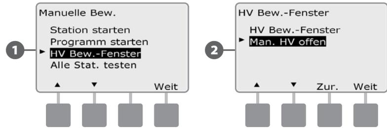
**3** Der Bildschirm „Man. HV öffnen“ wird angezeigt. Drücken Sie die Tasten „+“ und „-“, um die Dauer (in Stunden und Minuten) einzustellen, die das HV geöffnet wird. Drücken Sie dann „Weit“ (Weiter). „HV ist offen“ wird kurz angezeigt.
