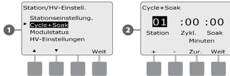
**3** Drücken Sie die Tasten „+“ und „-“, um die Zykluszeit einzustellen (1 bis 60 Minuten). Um Cycle+Soak für diese Station zu deaktivieren, geben Sie 0 Minuten ein. Drücken Sie dann „Weit“ (Weiter).
