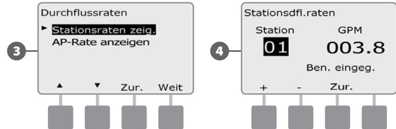
**!** **HINWEIS:** Die AP-Rate ist die maximale Durchflussrate für die Wasserquelle.
