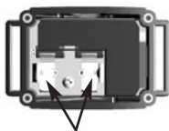
Reset : relier les 2 supports de pile
