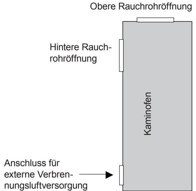
**Achten Sie bei einer externen Verbrennungsluftversorgung auf dichte Rohrführung!**
