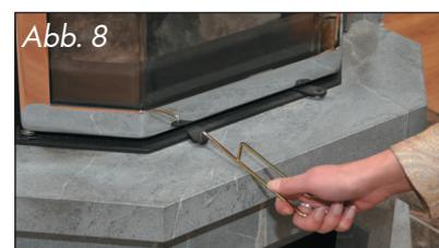
Sind auch diese Holzscheite rundherum angebrannt, sollten Feuerstätte und Abgassystem weitgehend die Betriebstemperatur erreicht haben. Jetzt können Sie die Primärluft-Einstelleinrichtung (links) auf "ZU" stellen (Abb. 8) und die Verbrennung hauptsächlich über die Sekundärluft-Einstelleinrichtung (rechts) regeln.
