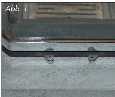
Entfernen Sie die Asche von der vorangegangenen Feuerung aus dem Feuerraum und leeren den Aschekasten. Bitte nehmen Sie vor dem Anheizen folgende Einstellungen vor: Stellen Sie die Primärluft- und die Sekundärluft-Einstelleinrichtung (Abb. 1) auf "AUF". Die Absperrklappe in der Verbrennungsleitung muss, soweit vorhanden, vollständig geöffnet werden.
