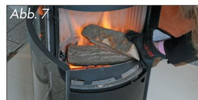
Legen Sie jetzt zwei weitere Holzscheite parallel zur Feuerungscheite auf und verschließen die Feuerraumtür (Abb. 7).
