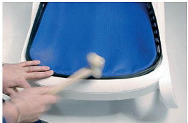
**10** Ist der Halterahmen in Position wird dieser bündig mit dem Hammer in den Liegenrahmen eingeschlagen.
