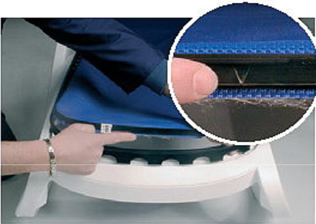
**7** Bespannung von der Mitte aus einlegen . ( die Mitte ist mit einem Pfeil gekennzeichnet)
