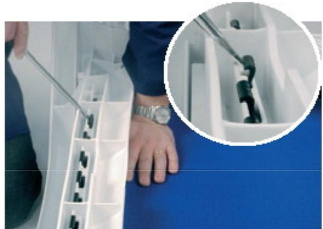
**2** Rahmen der Bespannung von unten auf der Liegefläche und dem Rückenteil aushacken. Durch Wegdrücken der schwarzen Halteklips.
