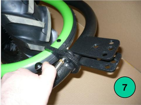
Abb. 7-10. Fall der UNITräger nicht benutzt wird, jedoch montiert bleiben soll, ist die Verriegelung der Befestigungsschelle (Befestigung am Grundrahmen) zu lösen und der UNITräger an die Transportmulde zu kippen. Die Arretierung in dieser Position erfolgt an der Bördelkante der Transportmulde durch die Positionsteile **b, c, d**.
